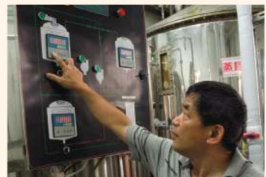
3. 水煮沸至72°C後加入碾碎麥芽攪拌，控制在68°C進行糖化約50分鐘。
