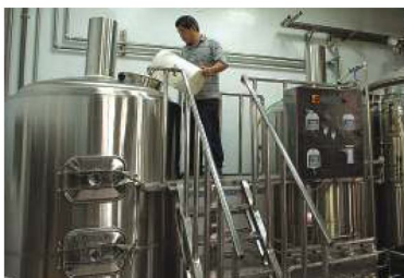
4. 導入煮沸鍋煮至100°C，放入啤酒花及玉荷包原汁，50分鐘後濾掉蛋白與雜質，經由冷熱交換器導入發酵罐。
