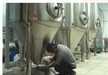
5. 加入上層酵母，透過夾套冷卻水降溫至12°C，進行發酵約七天，第二次加入玉荷包原汁。
