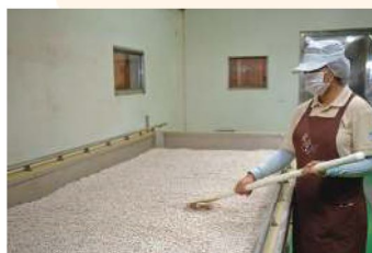
2. 接菌發酵，利用自行研發的溫控製麵設備，提高生產效能與品質。
